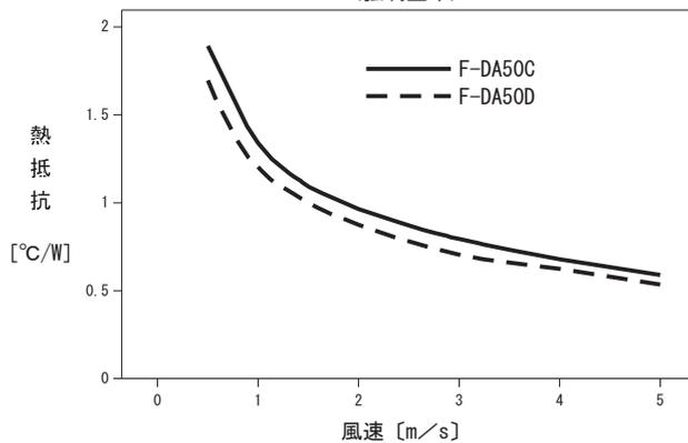
図2 F-DA50C、F-DA50D ヒートシンク熱抵抗
