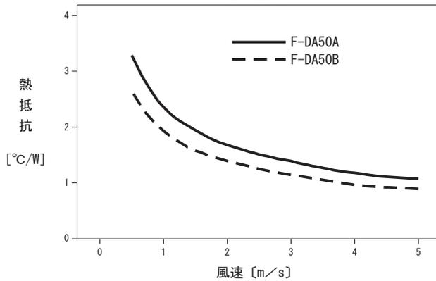
図1 F-DA50A、F-DA50B ヒートシンク熱抵抗
