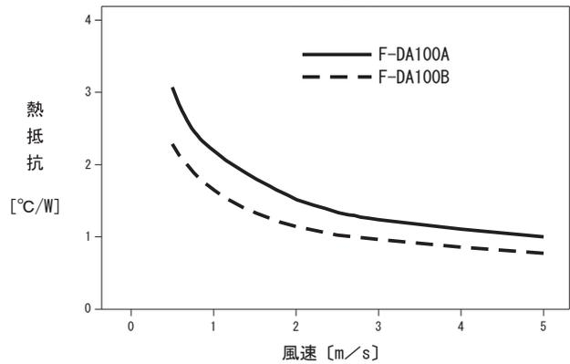
図3 F-DA100A、F-DA100B ヒートシンク熱抵抗
