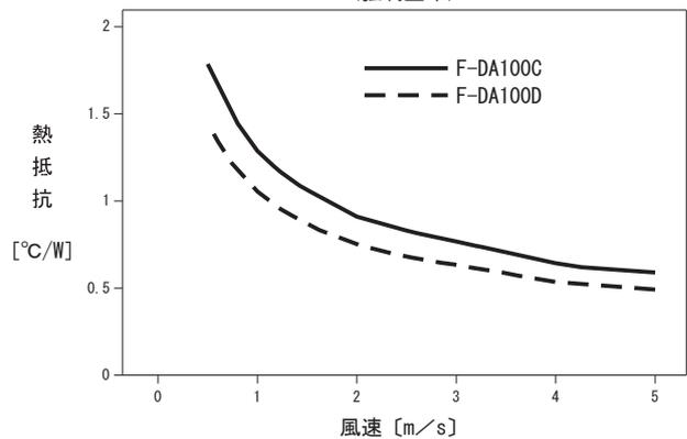
図4 F-DA100C、F-DA100D ヒートシンク熱抵抗
