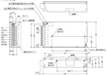
※ 質量:350g以下(カバーは含まず) ※カバーはオプション (表面処理:亜鉛メッキ) ※電源取付穴締め付けトルク: 0.6N・m(6.3kgf・cm) max
