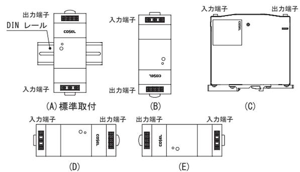
■DINレールに取り付ける場合は、確実にDINレールに取りつくよう、A部をレールの一端に引っ掛け、B方向に押し込んでください。取り外す際には、C部を押し下げるか、D部にドライバ等を差し込み引き外してください。取り外しにくい場合は、E部を押しながら作業してください。
