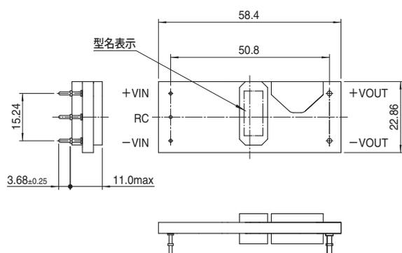
※ プリント基板推奨加工寸法 (オプションL5) (TOP VIEW)
