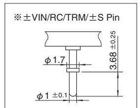
※ プリント基板推奨加工寸法 (TOP VIEW)
