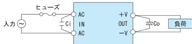
図3.1 出力端子外付けコンデンサ
