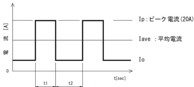
SNR シリーズは、以下に示す条件でピーク電流を流すことができます。ピーク電流によって Duty が変わりますので下図を参照してください。
