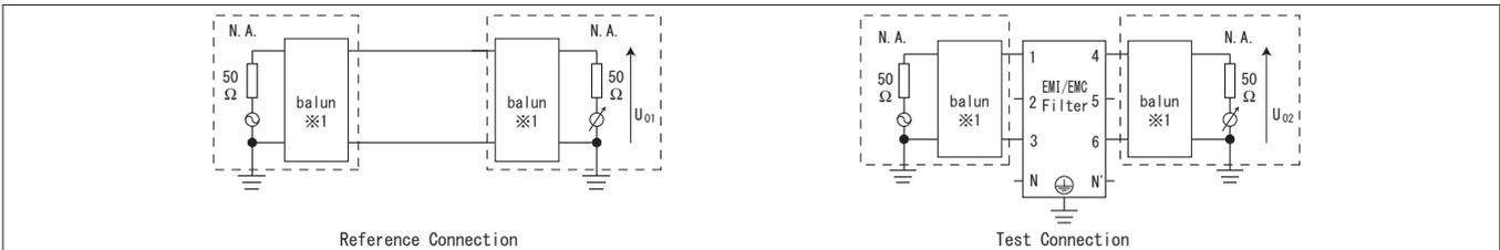
※1 測定器内のミックスモード Sパラメータによる平衡測定
