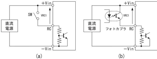
図3.1 リモートコントロールの使用例1
