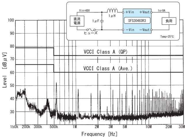
図2.3 SFS30483R3における雑音端子電圧測定例
