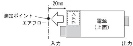
図5.7 ファン排気温度測定ポイント
