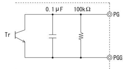
図 5.2 PG 信号の内部回路
