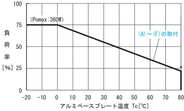
図3.7 伝導冷却におけるベースプレート温度ディレーティング (参考値)
