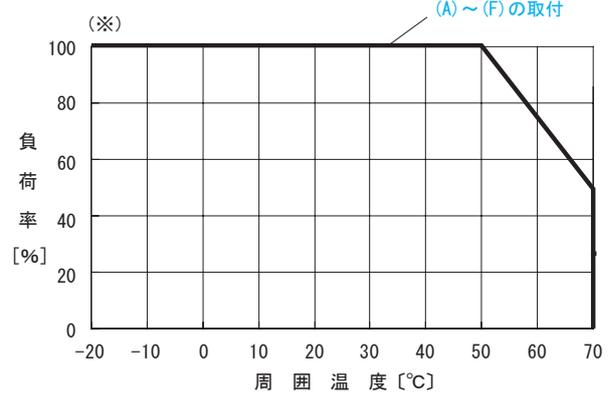
図3.4 強制通風における動作周囲温度ディレーティング（参考値）
