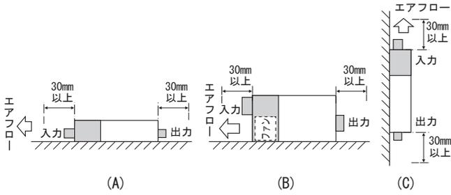
図 5.9 通風孔部とファン排気部のクリアランス
