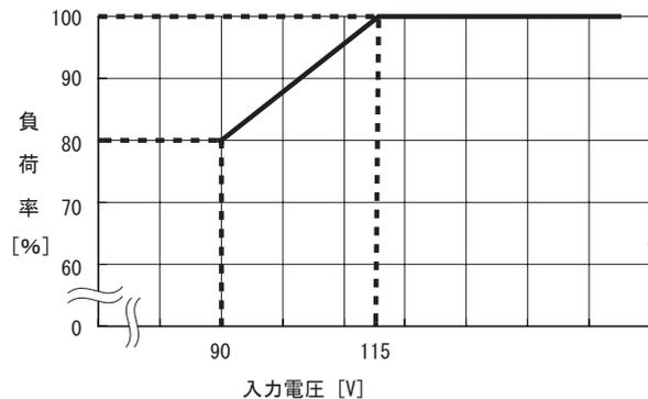
図3.10 入力電圧によるディレーティング
