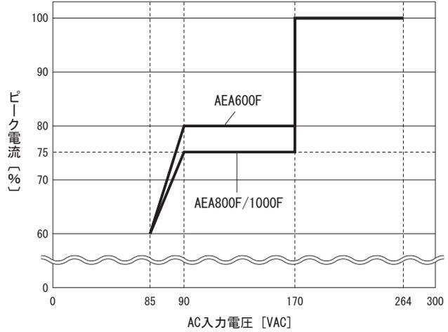
図4.3 入力電圧によるディレーティング
