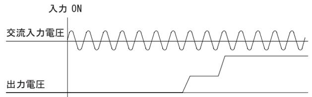
図2.3 直列・並列運転時の起動波形
