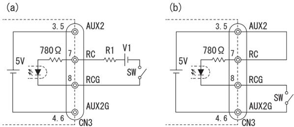
図6.5 リモートコントロール回路接続例
