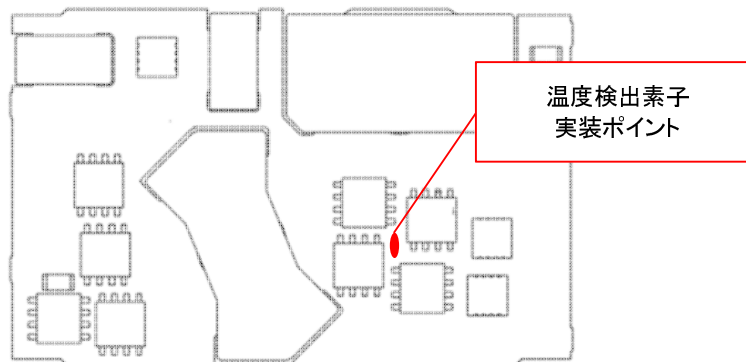
図6-3.3. CHS500-Iの温度測定ポイント(上面図)
