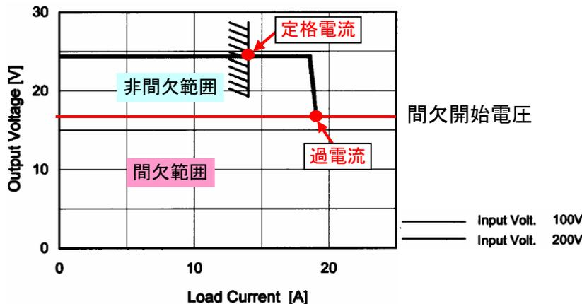
図11.2.1 間欠過電流動作(例:PBA300F-24 サンプルデータ)
