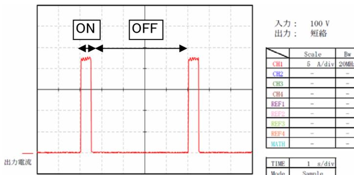
図11.2.2 間欠過電流時の出力電流波形(PBA300F-24)
