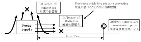
With the ambient temperature of graph, it measures in the environment of a figure. グラフの周囲温度とは、図の環境で測定したものです。
