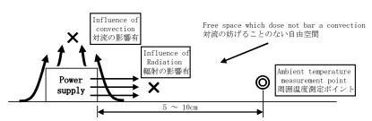
With the ambient temperature of graph, it measures in the environment of a figure グラフの周囲温度とは、図の環境で測定したものです。
