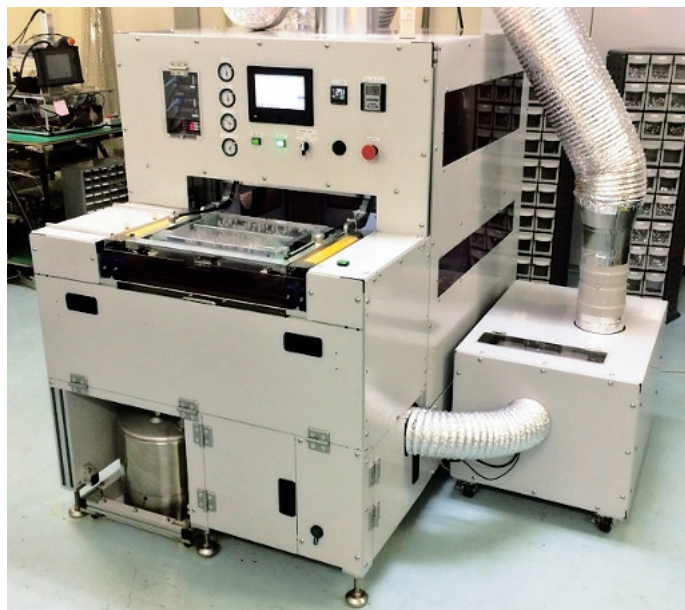
自社開発したはんだ付け装置
