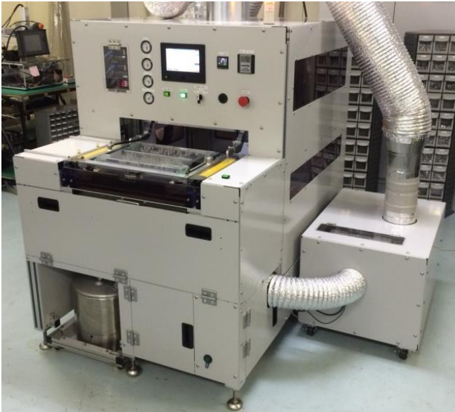
自社開発したはんだ付け装置
