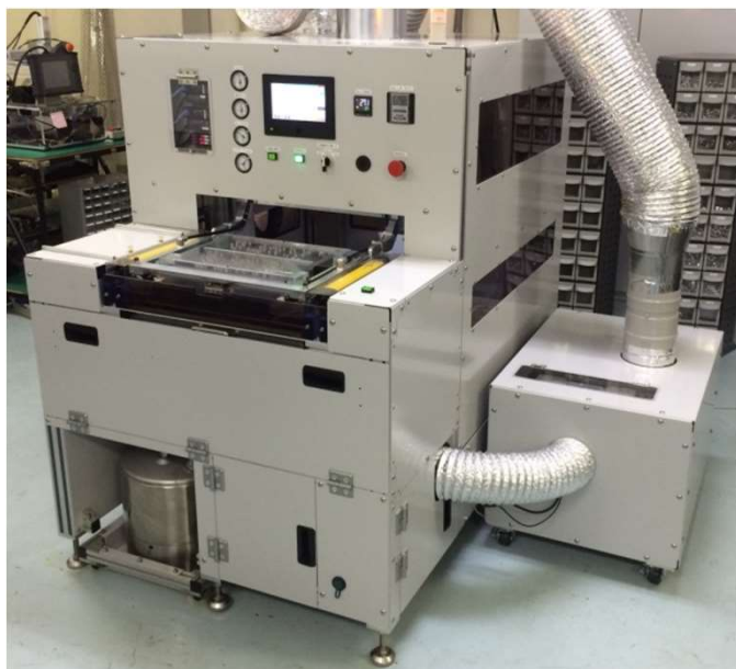
自社開発したはんだ付け装置
